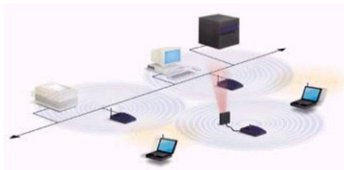
Hình 2.4. Cách sử dụng của một điểm mở rộng (EP)
