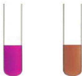
Hình 13.5. Ống nghiệm chứa dung dịch potassium permanganate trước (a) và sau khi được sục khí ethylene (b)
