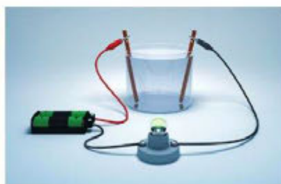
Hình 2.2. Thí nghiệm với dung dịch nước muối (a) và nước đường (b)
