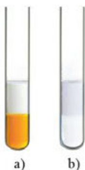
Hình 13.4. Ống nghiệm chứa nước bromine trước (a) và sau khi phản ứng với hex-1-ene (b)
