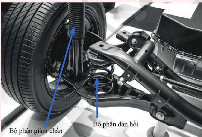
Hình 4.3. Bộ phận đòn hồi và bộ phận giảm chấn trong hệ thống treo của ô tô
