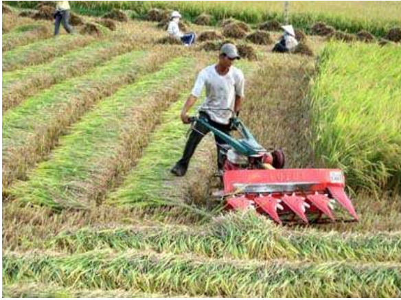
Hình 4.3.10. Máy gặt lúa xếp lớp
