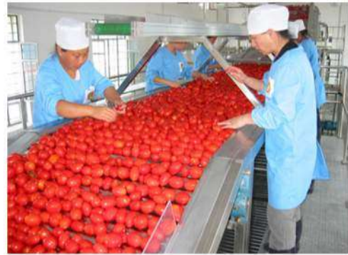
Hình 4.6.4. Phân loại bằng tay với sự hỗ trợ của băng chuyền
