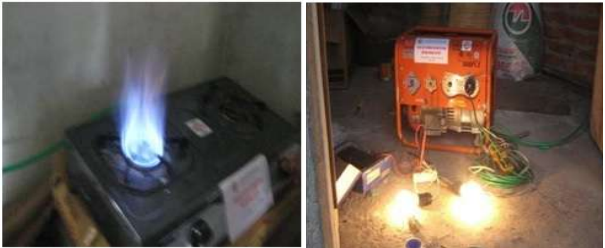
Hình 6.3.6. Thu hồi khí bioga để chạy máy phát điện và đun nấu
